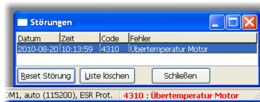
Bild 20: Anzeige von Störungen im Störungsfenster und in der Statuszeile
