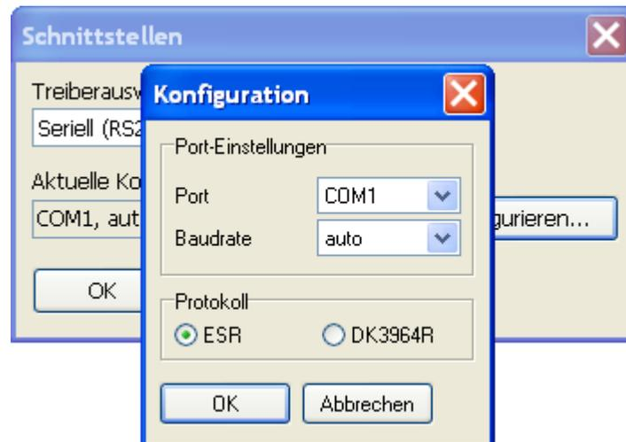
Bild 10: Schnittstelle konfigurieren
