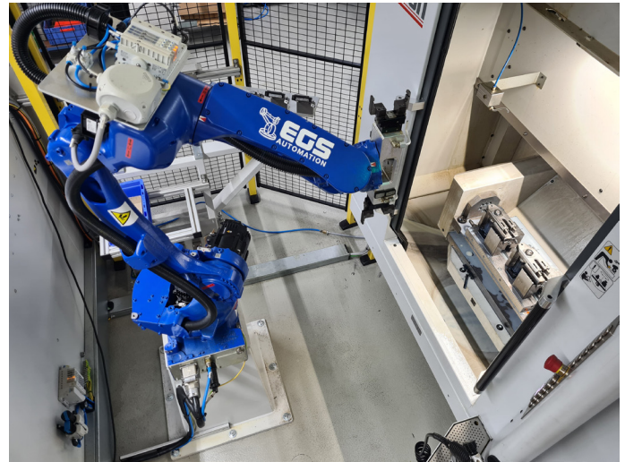
Der Yaskawa GP12 bei der Maschinenbeschickung. Wenn er in Ruheposition gefahren wird, bleibt vor der Maschine ausreichend Platz für Rüstvorgänge und das händische Be- und Entladen von Kleinserien
