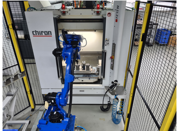
Der Roboter be- und entlädt das Bearbeitungszentrum hauptzeitparallel. Die Werkstückvorrichtungen werden vom Roboter vor dem Bestücken gereinigt.
