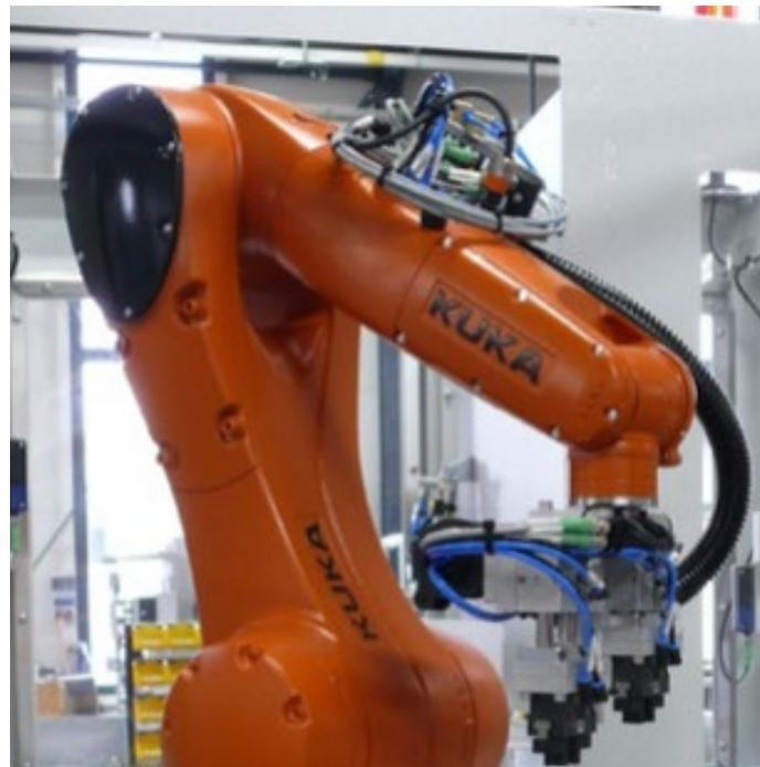
Die Medienversorgung von der ersten bis hoch zur dritten Roboterachse mit Luftleitungen bzw. elektrischen Adern ist in der Regel bei 6Achser Robotern bis zu einem gewissen Maß bereits im Roboter standardmäßig verbaut.
