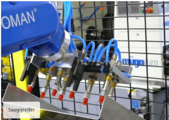
Es besteht aus dem eigentlichen Greifwerkzeug: einem pneumatischen oder elektrischen Greifelement oder Vakuumelement sowie entsprechenden werkstückspezifischen Formteilen, die mit den Bauteilen in Berührung kommen und diese sicher aufnehmen bzw. halten. Dies sind bei Greifern mit Hub sogenannte Greiferbacken, bei Vakuumgreifsystemen meist entsprechende Negativformen des Werkstücks oder von Teilen des Werkstücks.
