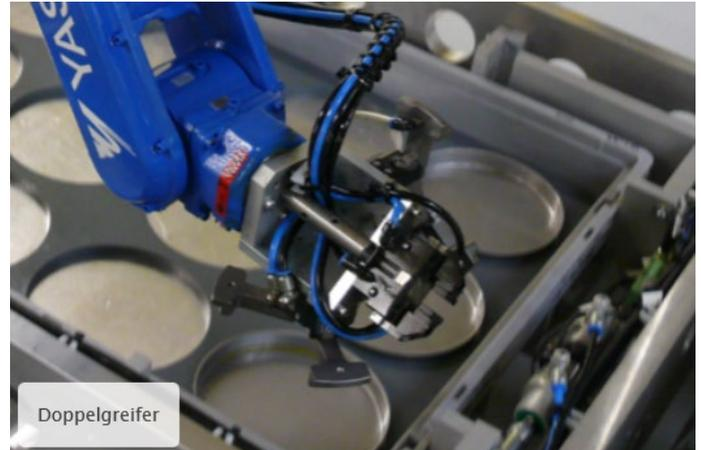
Mehrfach-Greifwerkzeuge werden auch sehr häufig verwendet um die Gesamttaktzeitvorgabe zu erreichen bzw. zu optimieren.
